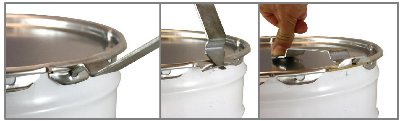
Das spitze Ende in ein Loch stecken. Öffner nach oben drehen Bis zum Anschlag am Deckel
