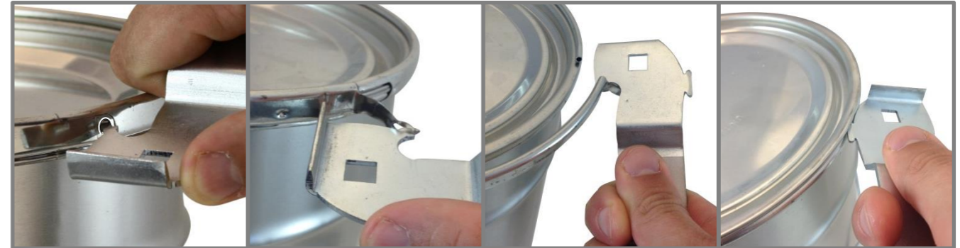
Dorn in die Spannringöffnung stecken Durch drehen des Öffners wird die Lasche angehoben Mit dem Dorn den Spannring öffnen Ohr zwischen Deckel und Eimerrand stecken
